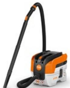
Aspiratore a batteria portatile per la pulizia di superfici bagnate e asciutte. Elevata potenza di aspirazione. Certificato per la classe di polveri L. Accessori integrati nella scocca per un cambio rapido e semplice tra bocchetta universale e bocchetta per fughe. Tubo flessibile di aspirazione a fisarmonica lungo 1,8 m, riponibile arrotolato, tubo di aspirazione in 2 parti. Dettagli del prodotto a pagina 258.
