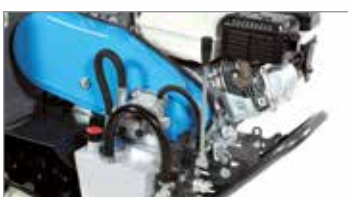
Distributore a leva per comando ribaltamento idraulico.
