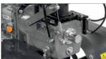
Trasmissione diretta ad ingranaggi sull'albero motore con frizione multidisco in bagno d'olio.
