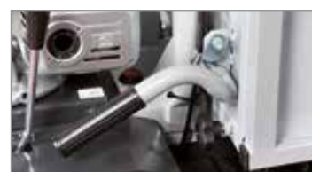
Ribalramento manuale con sistema di bloccaggio automatico.
